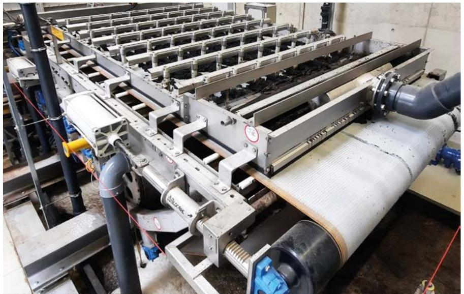
Die Materialien werden zur Entwässerung bei steigendem Druck auf einem Siebband über verschiedene Rollen und Walzen gegen ein zweites, wasserdurchlässiges Band gedrückt.
